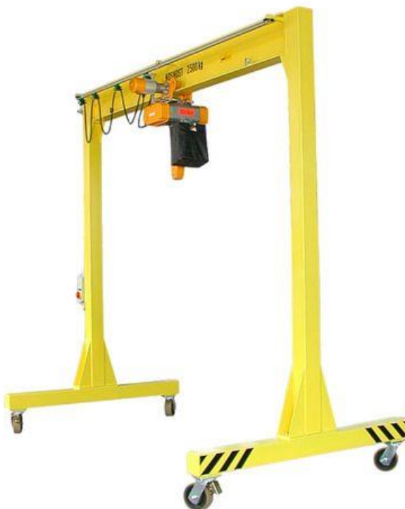
Obr. 8 Portálový jeřáb PJR [20]
