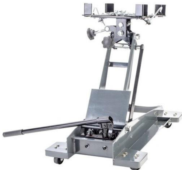
Obr. 5 Hydraulický zvedák převodovek [12]
