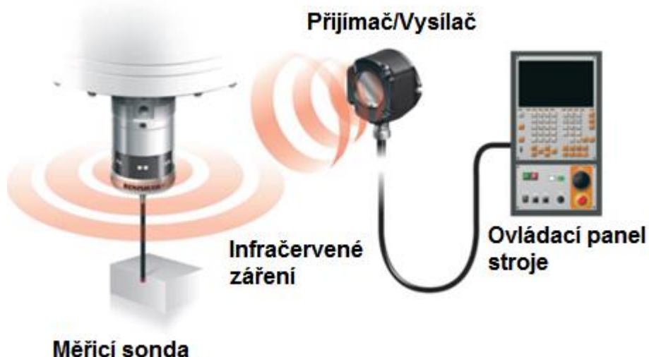
Obr. 1.7: Schéma optického přenosového systému [6].
