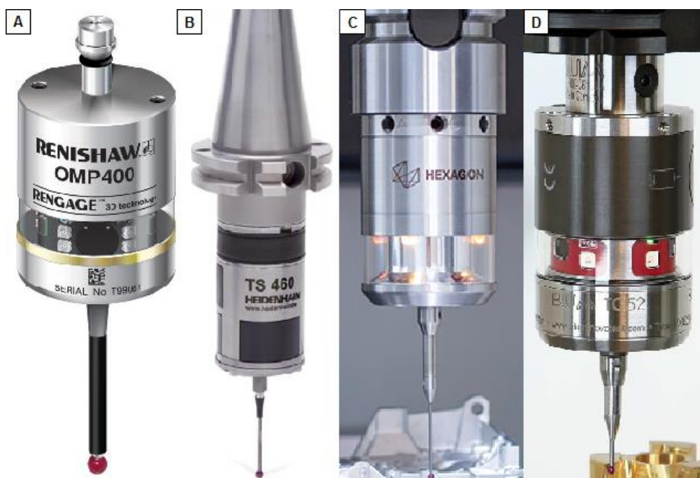
Obr. 1.11: Porovnávané dotkové obrobkové sondy (A – Renishaw OMP 400; B – Heidenhain TS 460; C – Hexagon IRP 40.02; D – Blum-Novotest TC 52) [10,13,14,15].
