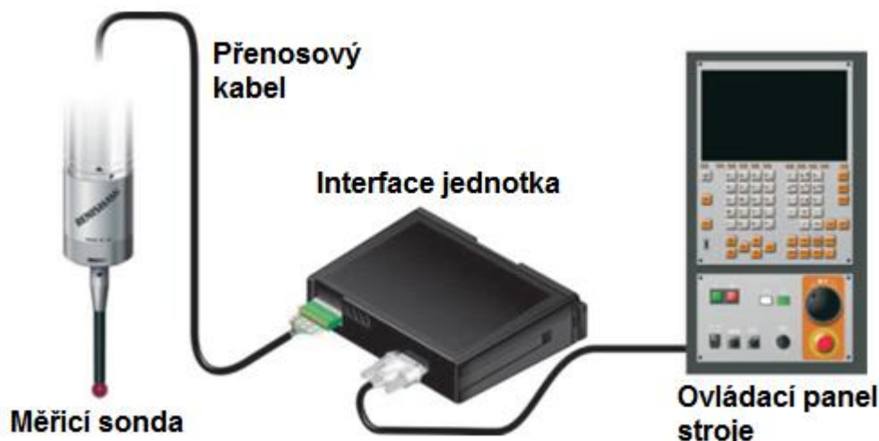
Obr. 1.9: Schéma kabelového přenosového systému [6].
