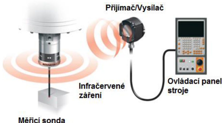
Obr. 1.7: Schéma optického přenosového systému [6].
