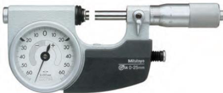
Obr. 1.17: Analogový passometr s úchylkoměrem Mitutoyo 510 [23].
