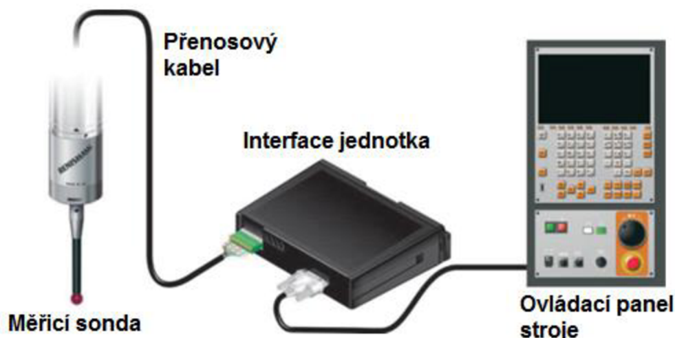
Obr. 1.9: Schéma kabelového přenosového systému [6].
