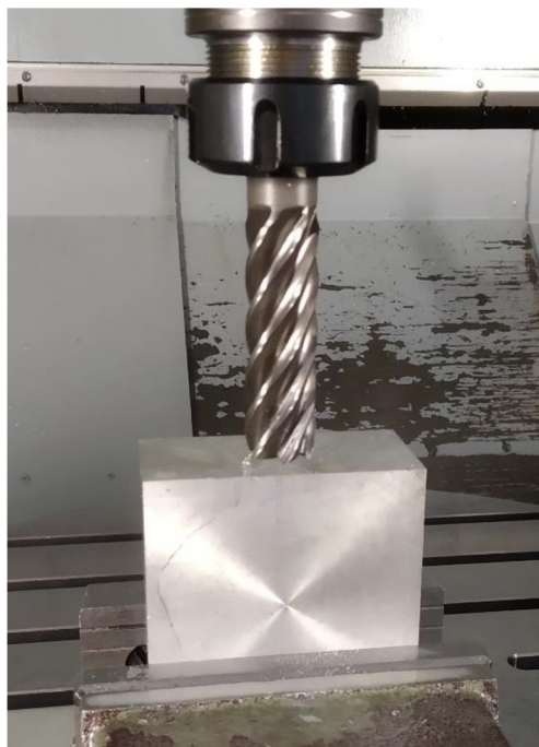
Obr. 4.20: Proces naškrábnutí polotovaru obrobku.
