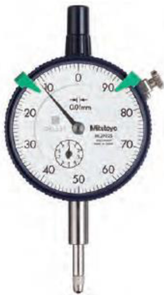
Obr. 1.16: Číselníkový úchylkoměr Mitutoyo 2046S [23].
