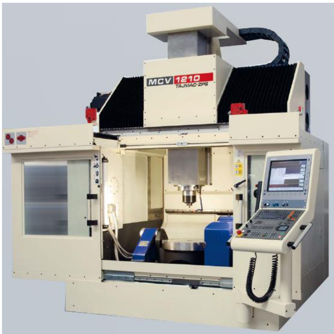
Obr. 3.1: Pětiosé obráběcí CNC centrum MCV 1210 [34].
