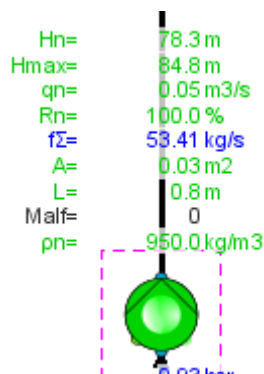
Obrázek 50: Aktivní čerpadlo 1TH41D01 se sledovanými hodnotami.
