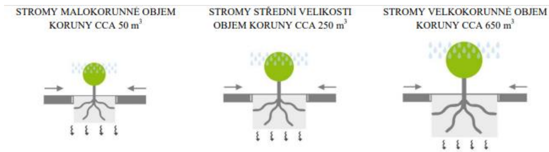
Obrázek 24: Minimální velikost prokořenitelného objemu půdy podle velikosti koruny stromu (Treewalker, s.r.o., ©2018.)
