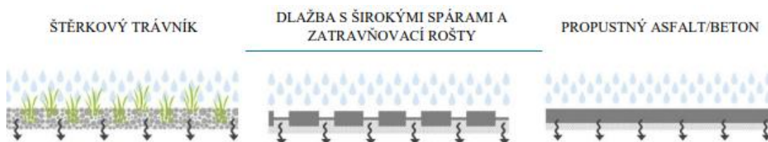
Obrázek 14: Systémy plošného vsakování (JV PROJEKT HV s.r.o., ©2018)
