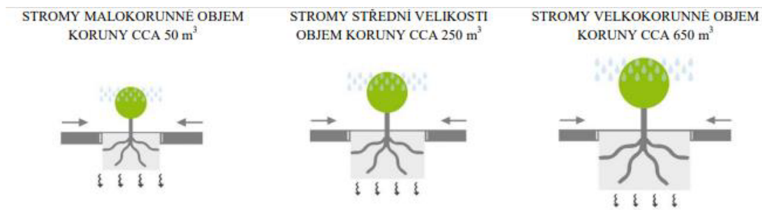
Obrázek 24: Minimální velikost prokořennitelného objemu půdy podle velikosti koruny stromu (Treewalker, s.r.o., ©2018.)
