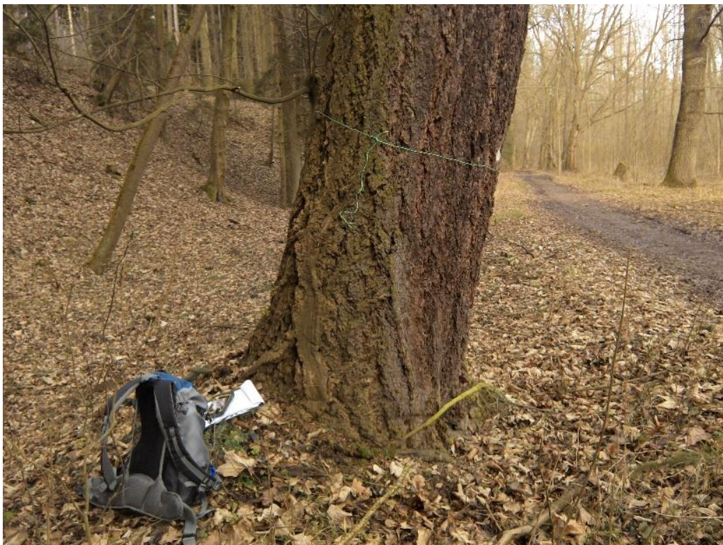
3 Měření obvodu pomocí provázku
