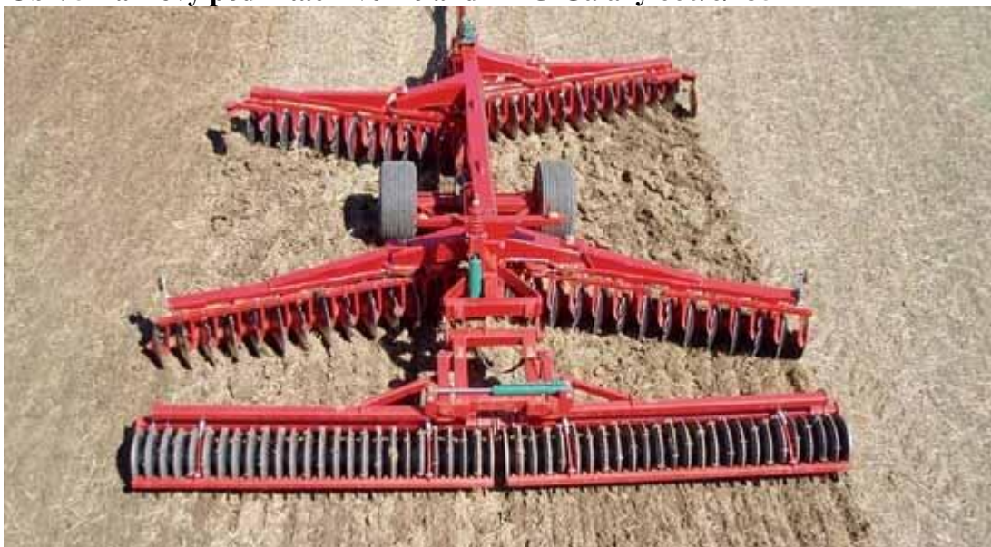
Obr. 5 Talířový podmítač Kverneland DXG-Galaxy 660/6/235
