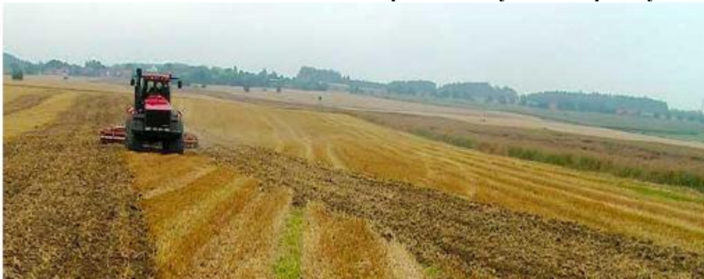
Obr. 16 Asistované řízení navede traktor přesně do vynechané polohy
