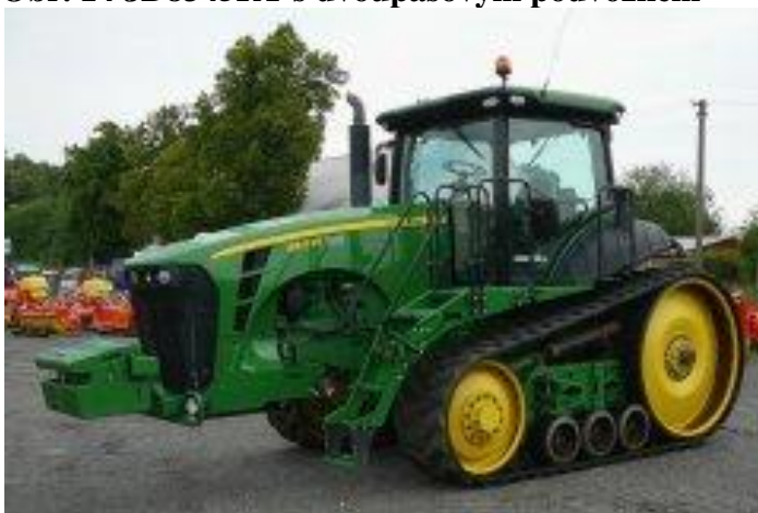
Obr. 14 JD8345RT s dvoupásovým podvozkem
