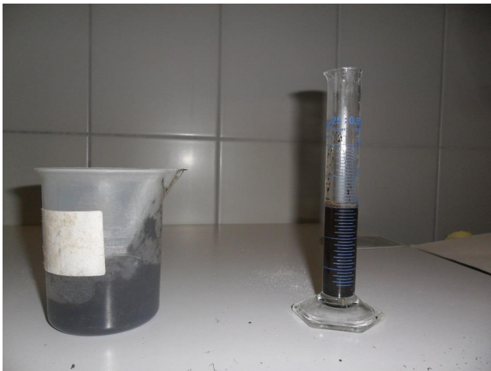
Obr. č. 44 – Stanovení vodní kapacity (WHC) (Čoček, 2016)
