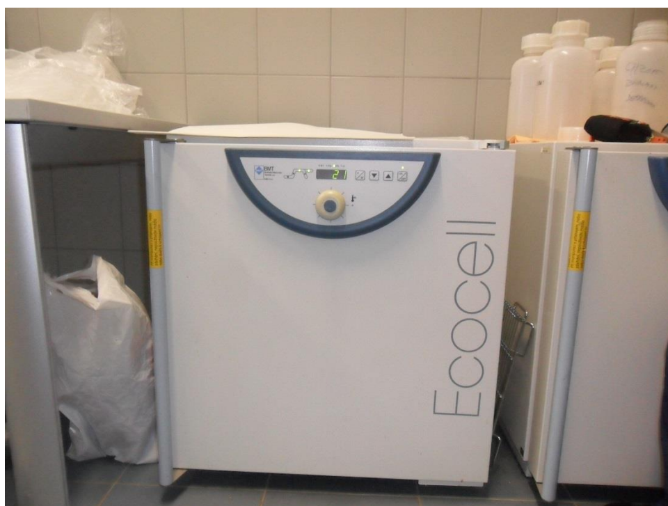
Obr. č. 49 – Sušárna EcoCell nastavena na teplotu 25 °C (Čoček, 2016)
