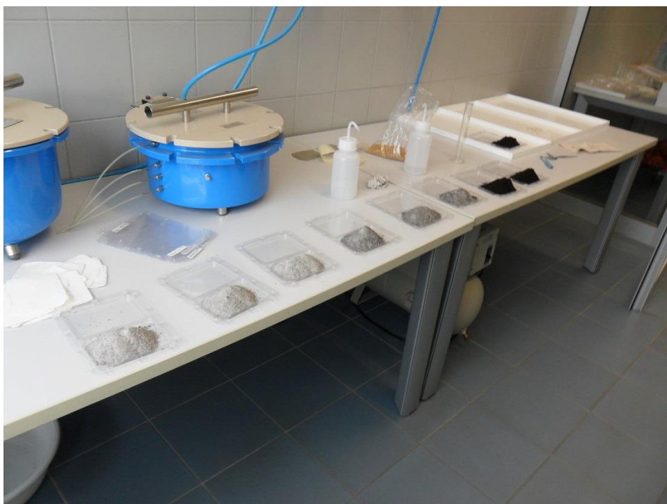
Obr. č. 45 – Chystání OECD půdy a kompostu do vzorkovnic (Čoček, 2016)
