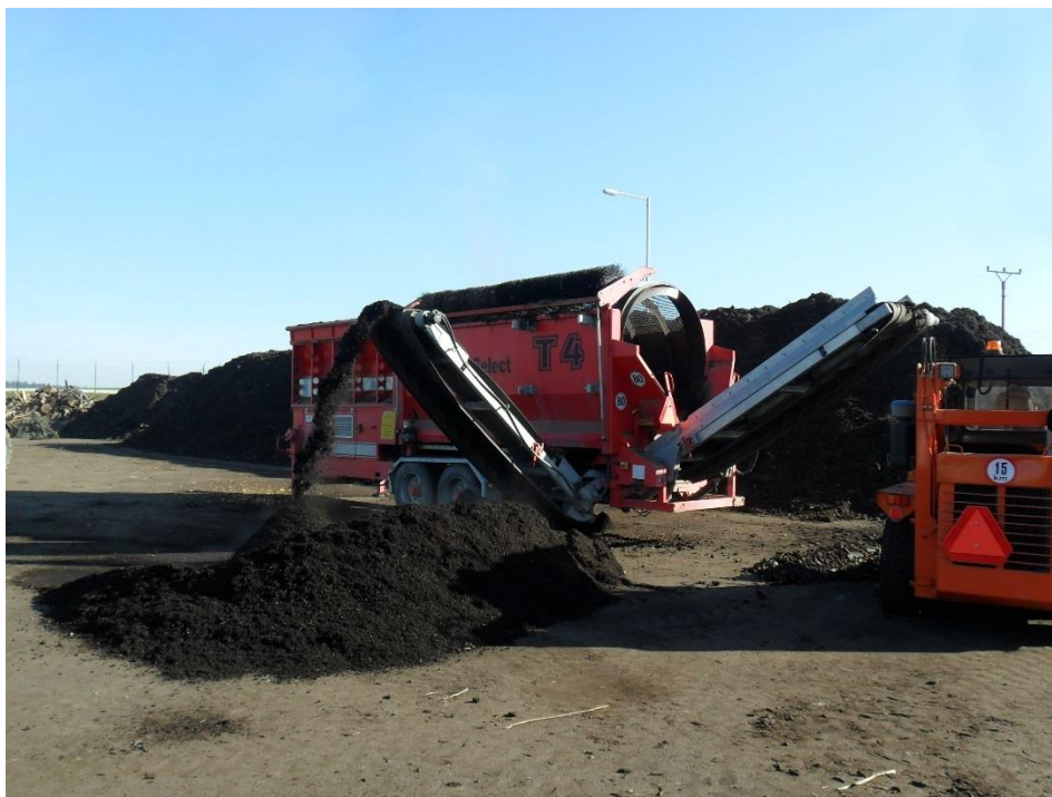
Obr. č. 40 – Oddělení jemné a hrubé frakce kompostu (Čoček, 2015)
