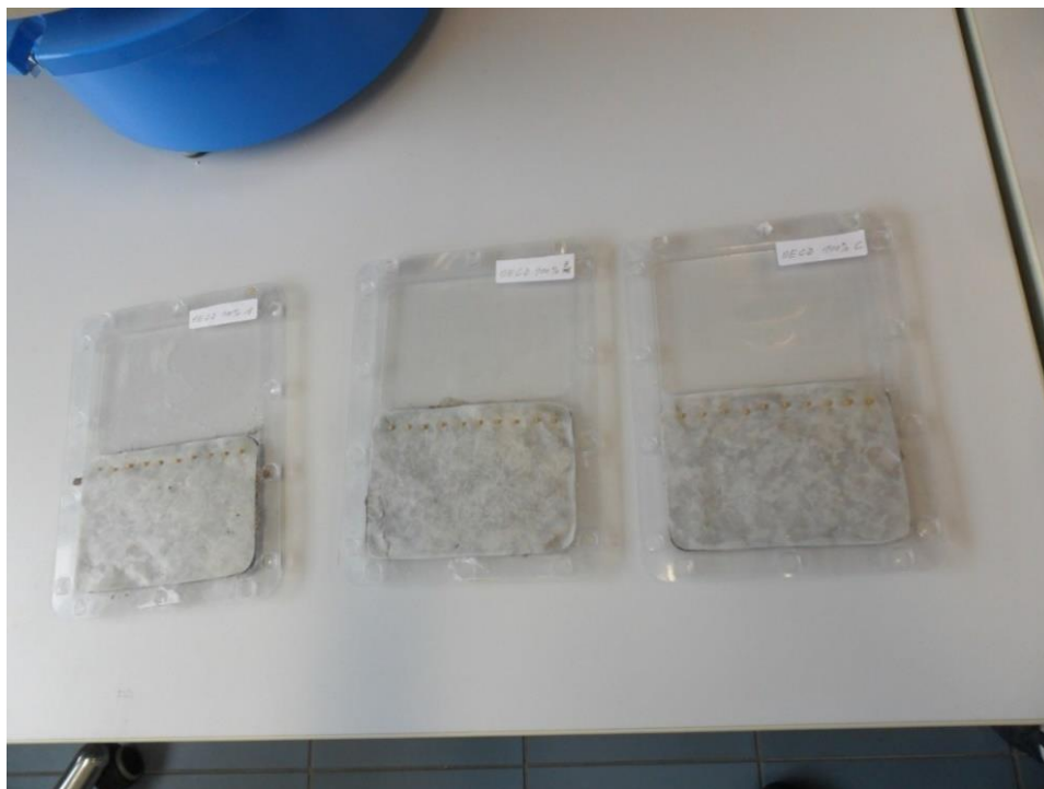
Obr. č. 13 – Vzorkovnice s OECD půdou a hořčicí bílou ( Sinapis alba L.) (Čoček, 2016)
