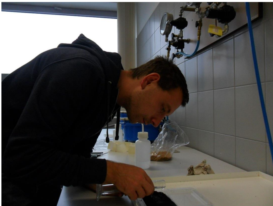
Obr. č. 46 – Zalívání kompostu destilovanou vodou (Čoček, 2016)
