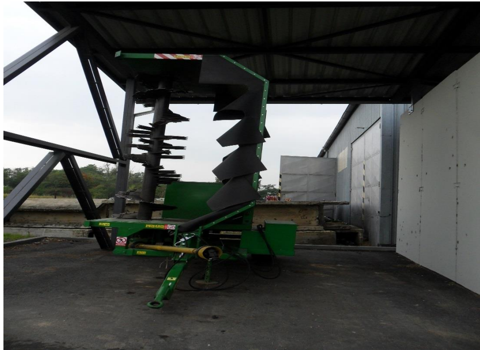
Obr. č. 10 – Překopávač kompostu EAK 1500 (Čoček, 2015)
