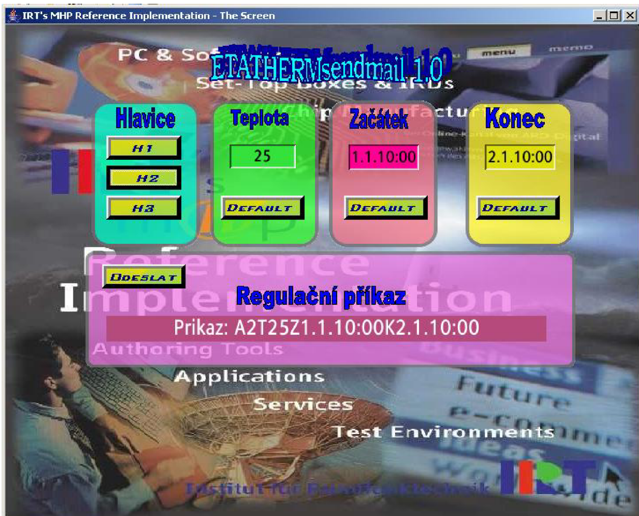
obr. 30 MHP aplikace EtathermSendmail 1.0 s nastaveným a odeslaným příkazem ( nastavení teploty 25° na adrese č. 2, datum a čas začátku 1.1.10:00, datum a čas konce 2.1.10:00)
