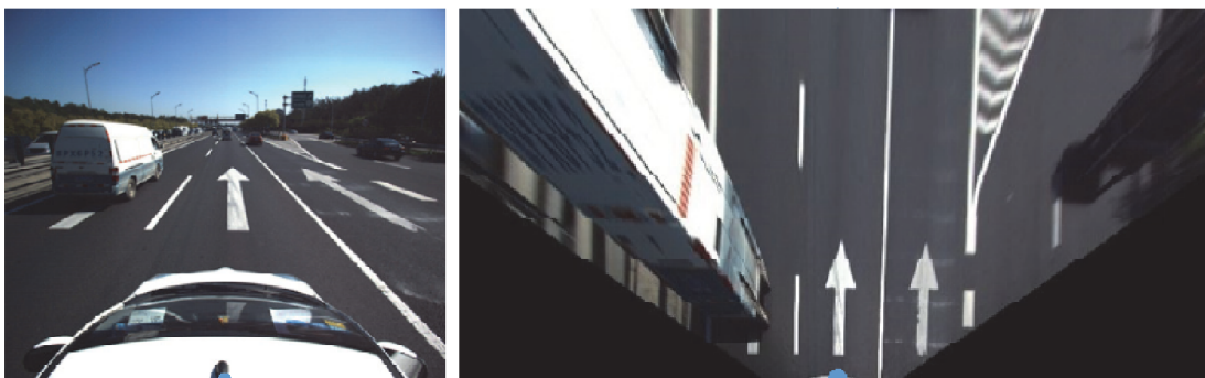
Obr. 4.1: Príklad inverznej perspektívnej transformácie obrazu z prednej kamery. Na výslednom pohľade zhora je možné vidieť, že čiary sú rovnobežné, ale okoloidúce vozidlá sú deformované.
