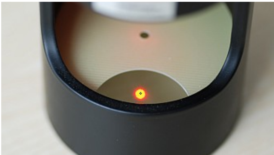
Obrázek 8.4: Detail stopy laserového svazku v rovině základny čtečky; skutečná velikost spotu je vyznačena kroužkem. © Optaglio, s.r.o.
