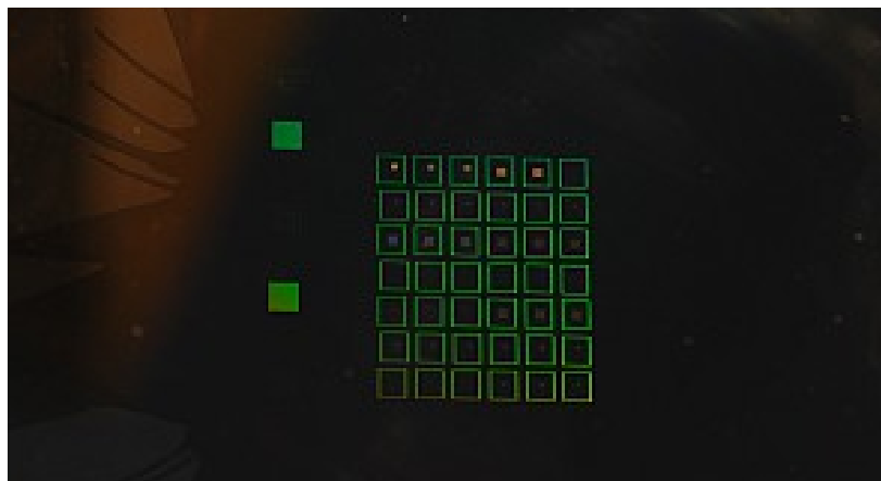
Obrázek 8.2: Křemíkový wafer s vrstvou PMMA a v ní naexponovanými a vyvolanými testovacími počítačem generovanými hologramy. © Optaglio, s.r.o.
