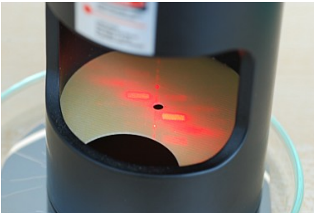
Obrázek 8.11: Laserovou čtečkou zrekonstruovaný syntetický hologram z difrakční struktury na obrázku 8.10. © Optaglio, s.r.o.
