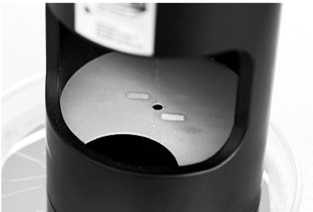
Obrázek 8.12: Laserovou čtečkou zrekonstruovaný syntetický hologram z difrakční struktury na obrázku 8.10, obraz byl počítačově zpracován aby lépe odpovídal skutečnému pozorovanému obrazu © Optaglio, s.r.o.
