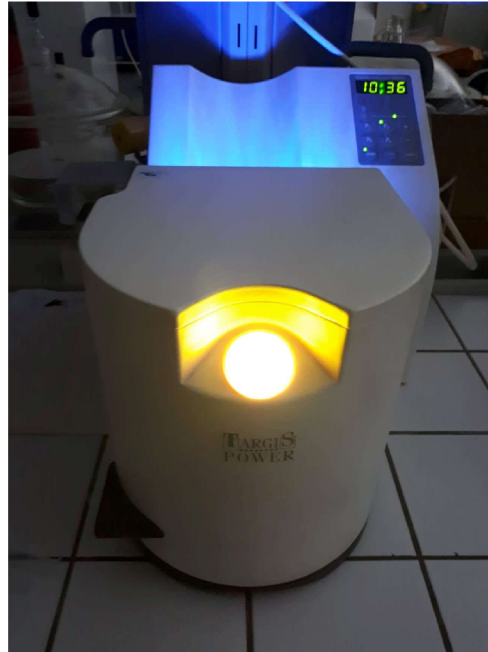
Obrázek 17 Fotokomora od firmy Ivoclar pro vytvrzení vzorků na DMA
