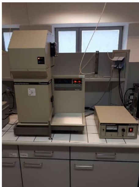
Obrázek 19 Přístroj pro měření DPC od TA Instruments s reakční celou (vlevo) a část přístroje DPC sloužící pro nastavení obloukové lampy (vpravo)
