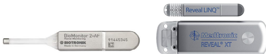
Obrázek 1.3 Implantabilní EKG záznamník BioMonitor 2 (Biotronik, vlevo) a Reveal™ XT a Reveal LINQ™ (Medtronic, vpravo). Zdroj: vlastní
