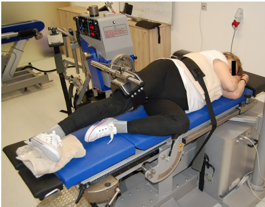
Příloha 7. Nastavení přístroje Isomed při testování maximální izokinetické svalové síly abduktorů a adduktorů kyčelního kloubu
