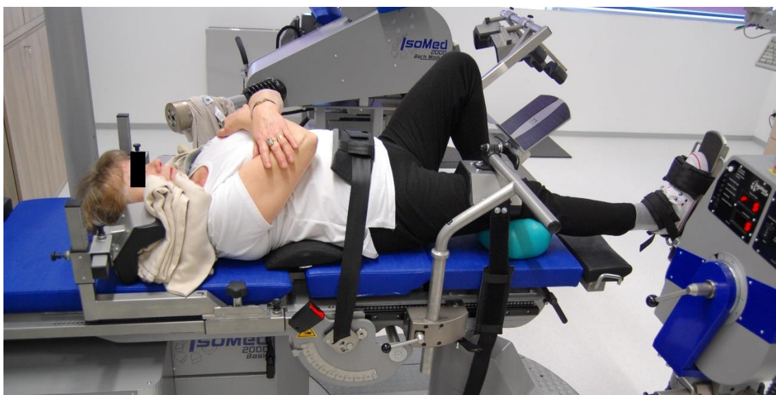
Příloha 5. Nastavení přístroje Isomed při testování maximální izokinetické svalové síly plantárních a dorzálních flexorů hlezenního kloubu
