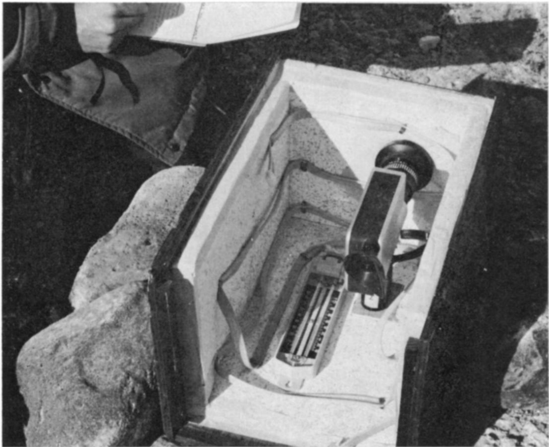
Obrázek 3 Kamera 8 mm (Braun-Nizo S 80) uložená v izolovaném pouzdře vyhříváném odporovým termostatickým páskem.
