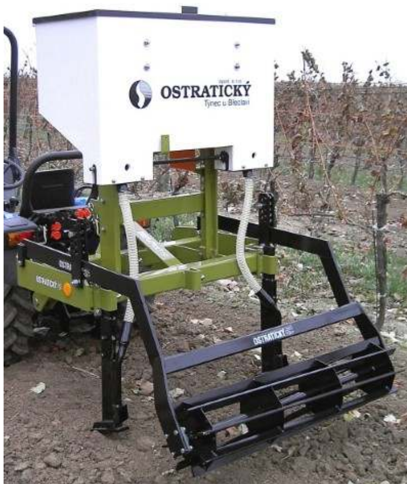
Obr. 2 Stroj pro hnojení HKO 100 mini – hloubkový kypřič
