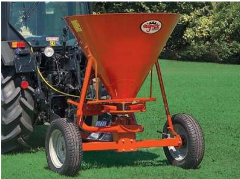
Obr. 3 Rozmetadlo průmyslových hnojiv XAR (nosnost 400 kg)
