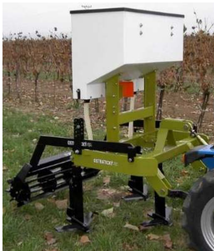
Obr. 1 Stroj pro hnojení HKO 180 Vario – hloubkový kypřič
