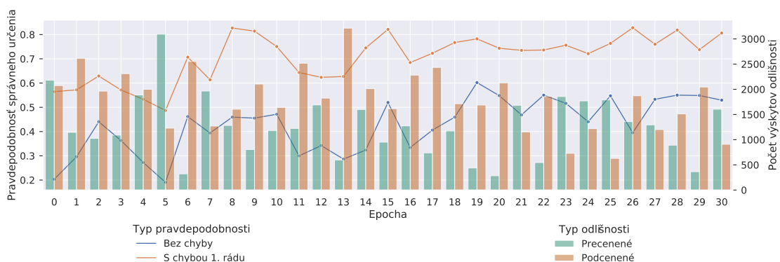
Obr. 7.13: Súhrnný výsledok experimentu 6. Evaluácia po 31 epoche má slabé výsledky. Riešením je zvýšenie počtu epoch, prípadne zníženie miery augmentácie.
