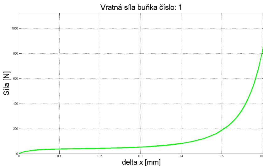
Obrázek 4.19: Vratná síla první buňky při kvazistatickém zatěžování a vlivu ztráty stability
