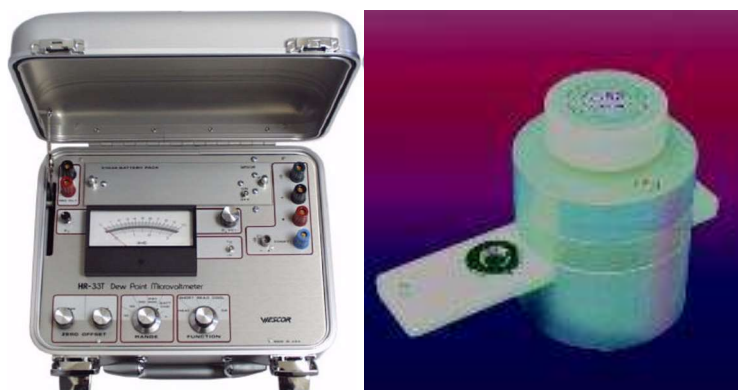
Obrázek 12 - HR-33T Dew Point Microvoltmeter, komora C-52 (Wescor, USA) (převzato z manuálu k přístroji WESCOR, 1988).
