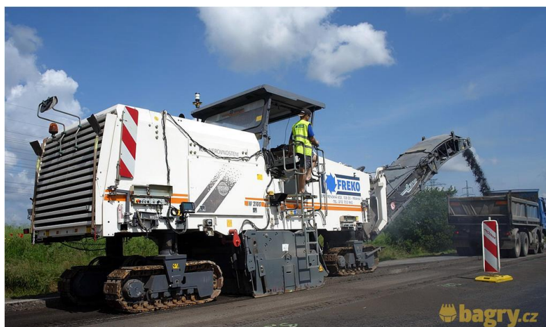
Obrázek 4: Silniční fréza wirtgen w2100 [13]
