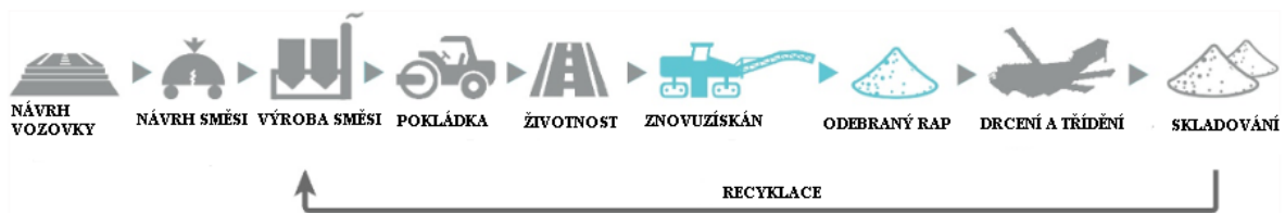
Obrázek 2: Schéma koloběhu recyklovaného materiálu [11]
