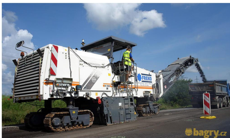
Obrázek 4: Silniční fréza wirtgen w2100 [13]
