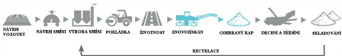
Obrázek 2: Schéma koloběhu recyklovaného materiálu [11]
