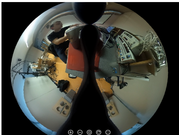
Obr. 6.1.2: Stitching videa nahraného pomocou Live stream režimu. Výsledok by mala byť celistvá guľa, no ako je možné vidieť na obrázku, v určitých miestach zostal nespojený obraz.
