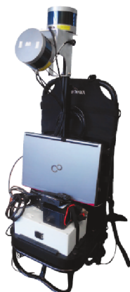
Obr. 4.5.5: Prototyp zariadenia „do batohu“. Na obrázku je platforma ešte bez kamery, výber a použitie sférickej kamery je súčasťou tejto práce.
