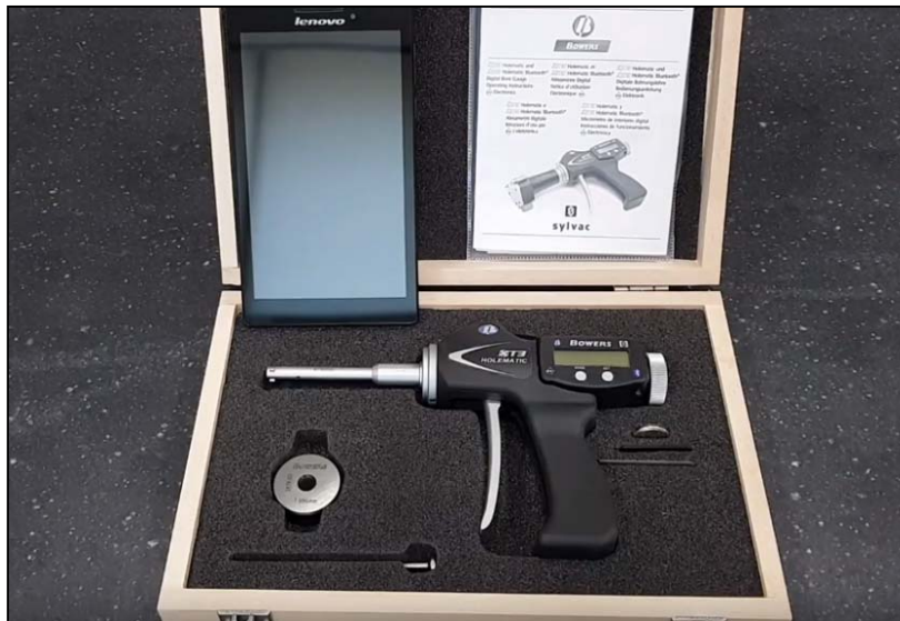
Obrázek 17: Digitální dutinoměr Bowers XT3 (Zdroj: vlastní zpracování)
