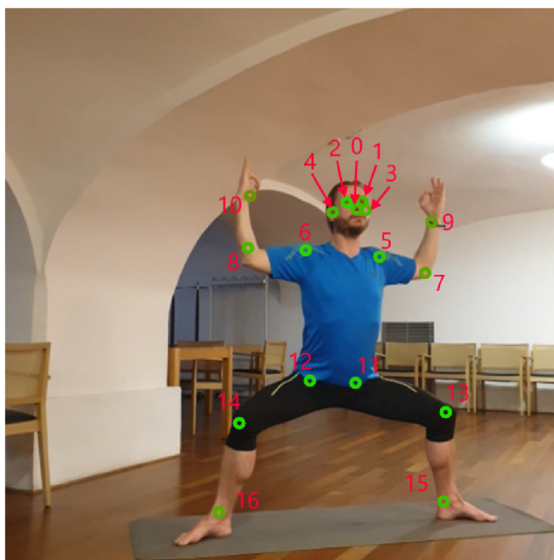
Obr. 3.5: Jednotlivé kľúčové body tela vrátane ich indexov vo výstupnom vektore modelu. Farba bodu značí hodnotu spoľahlivosti na škále od zelenej farbe k červenej, pričom sýta zelená znamená, že si je model veľmi istý.
