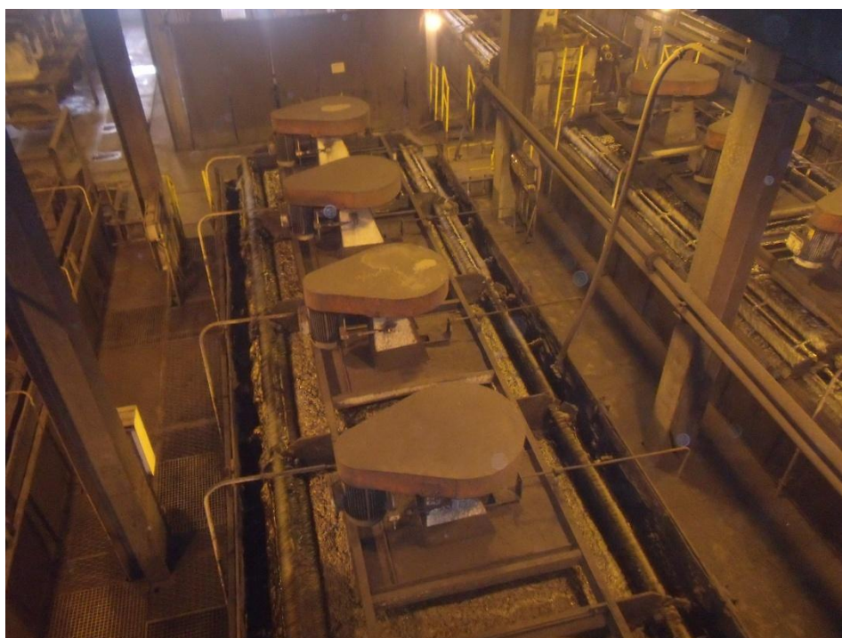
Obrázek č. 8: Flotační linky - flotátory (zdroj OKD, a.s.)
