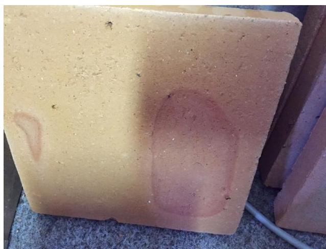
Obrázek č. 16: Cihelná dlažba se skvrnou od flotační hlušiny (zdroj Cihelna Polom)
