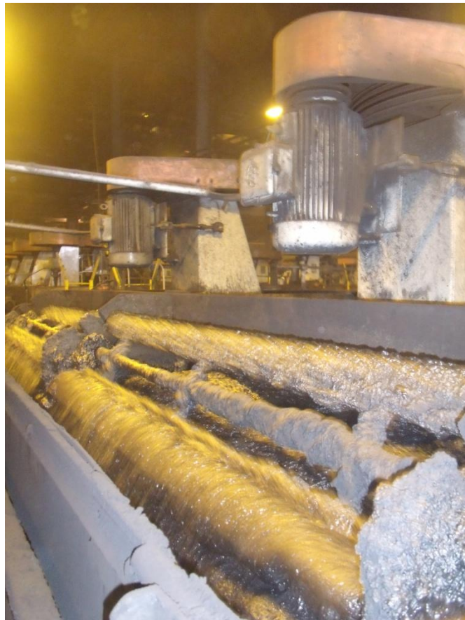
Obrázek č. 9: Stěr pěny obsahující uhelné částice (zdroj OKD, a.s.)
