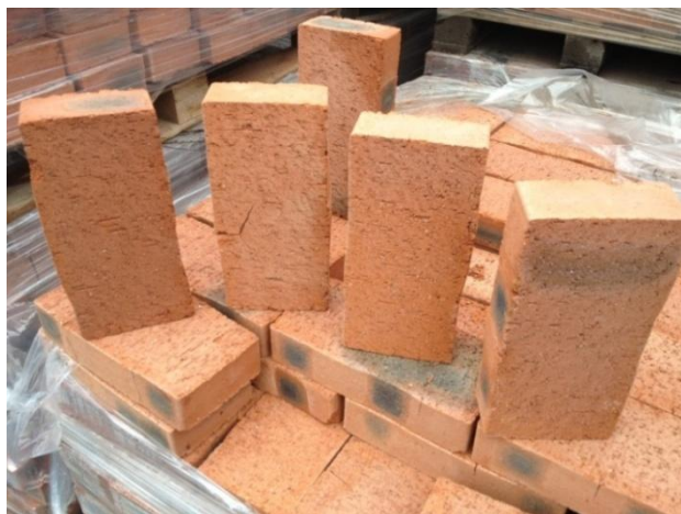
Obrázek č. 15: Cihla plná s nevypáleným zbytkem flotační hlušiny (zdroj Cihelna Polom)
