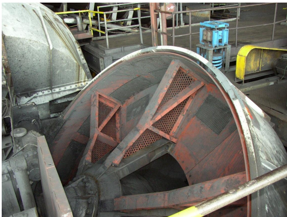
Obrázek č. 2: Těžkokapalinový rozdružovač Drewboy (zdroj OKD, a.s.)
