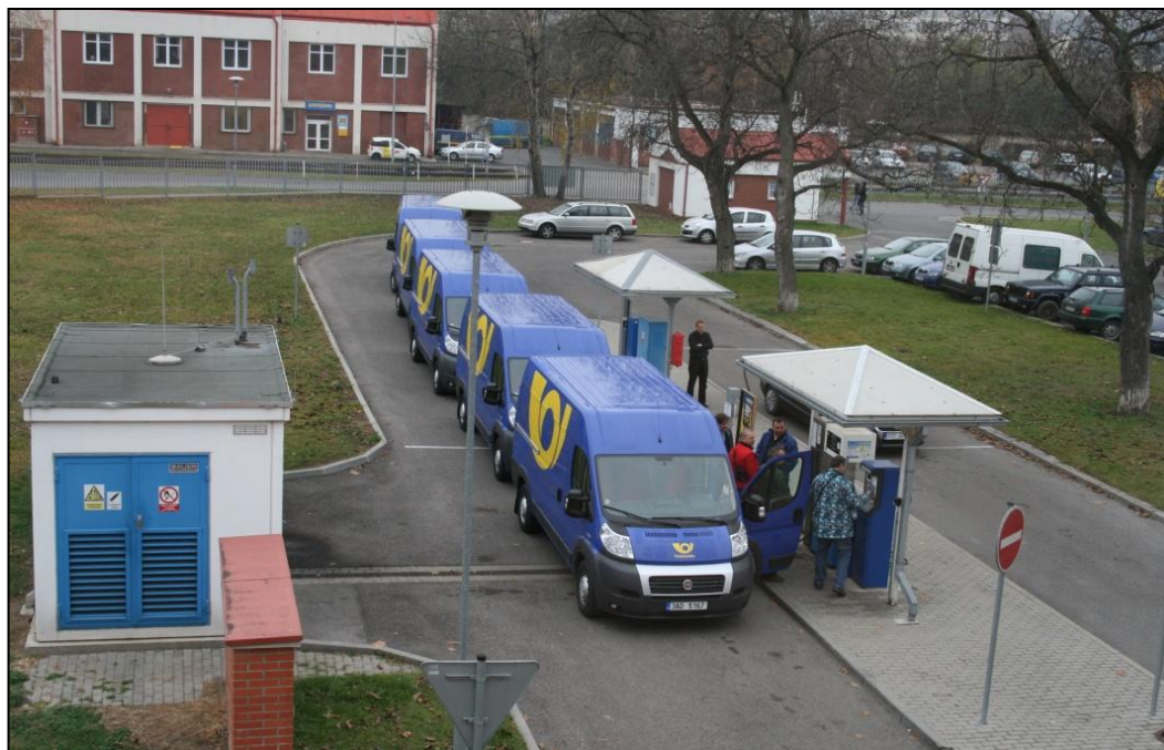
Obrázek 1: Česká pošta, s. p. - vozy s pohonem na CNG u plnicí stanice
