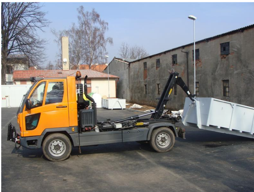
Obrázek 24: Svozové vozidlo Kultivar M30 – nosič kontejnerů, při nakládání kontejneru
