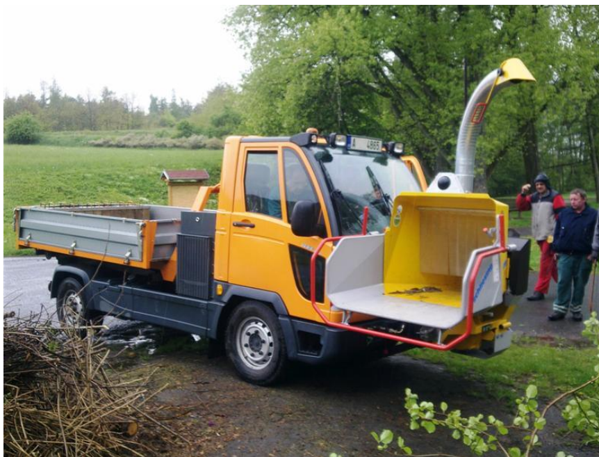
Obrázek 25: Nesený štěpkovač na Multicar M30 při zpracování větví
