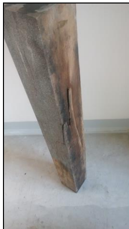
Obr. 62 - Vzorek č.3 ze skupiny Masiv mokrý, po zkoušce
