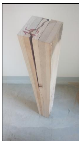
Obr. 52 - Vzorek č.3 ze skupiny Lepený suchý červený, po zkoušce
