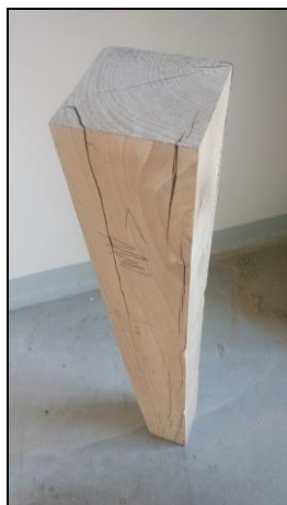
Obr. 59 - Vzorek č.5 ze skupiny Masiv suchý, po zkoušce
