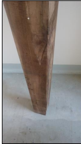
Obr. 60 - Vzorek č.1 ze skupiny Masiv mokrý, po zkoušce
