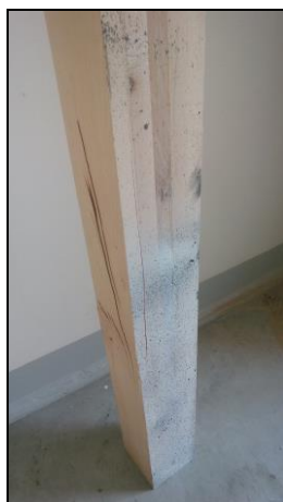
Obr. 48- Vzorek č.4 ze skupiny Lepený suchý černý, po zkoušce
