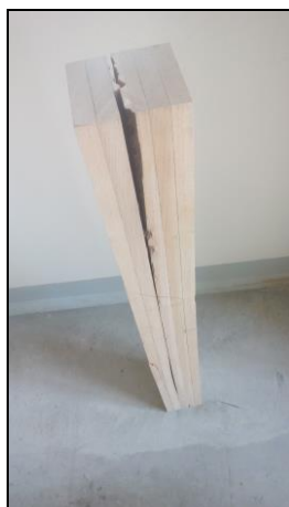
Obr. 54 - Vzorek č.5 ze skupiny Lepený suchý červený, po zkoušce
