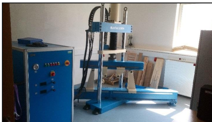
Obr. 13: Univerzální zkušební stroj LabTest 6.500H
