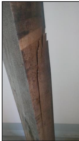
Obr. 61 - Vzorek č.2 ze skupiny Masiv mokrý, po zkoušce
