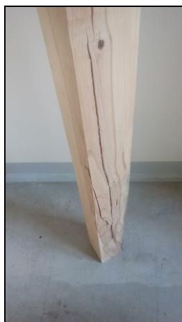
Obr. 58 - Vzorek č.4 ze skupiny Masiv suchý, po zkoušce
