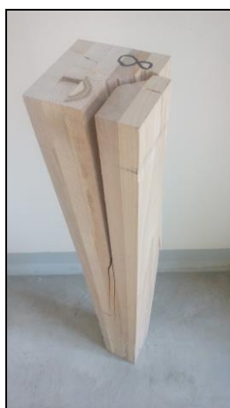
Obr. 47- Vzorek č.3 ze skupiny Lepený suchý černý, po zkoušce
