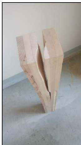
Obr. 46- Vzorek č.2 ze skupiny Lepený suchý černý, po zkoušce
