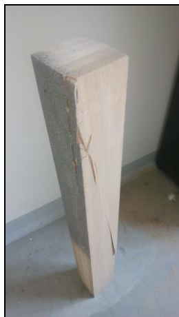
Obr. 45- Vzorek č.1 ze skupiny Lepený suchý černý, po zkoušce
