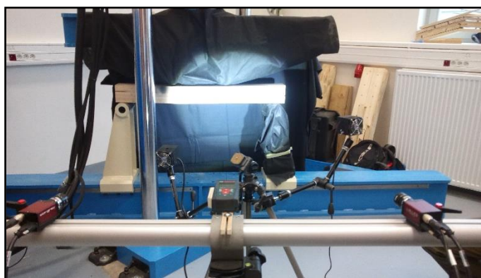
Obr. 14: Experimentální nastavení 4-bodé ohybové zkoušky s optickým snímáním deformací
