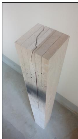
Obr. 50 - Vzorek č.1 ze skupiny Lepený suchý červený, po zkoušce
