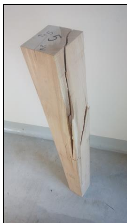
Obr. 57 - Vzorek č.3 ze skupiny Masiv suchý, po zkoušce
