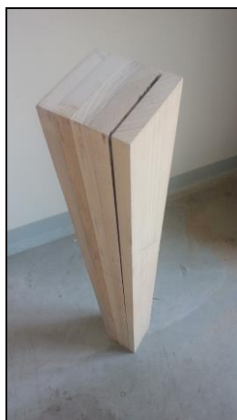
Obr. 53 - Vzorek č.4 ze skupiny Lepený suchý červený, po zkoušce
