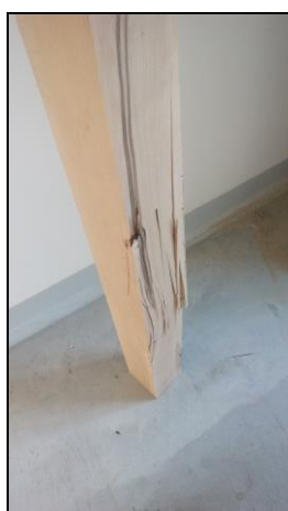
Obr. 55 - Vzorek č.1 ze skupiny Masiv suchý, po zkoušce
