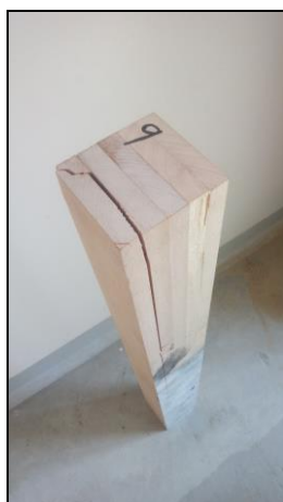
Obr. 49 - Vzorek č.5 ze skupiny Lepený suchý černý, po zkoušce
