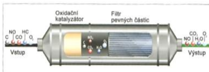
Obrázek č. 15 – Oxidační katalyzátor s principem činnosti CRT, zdroj:
