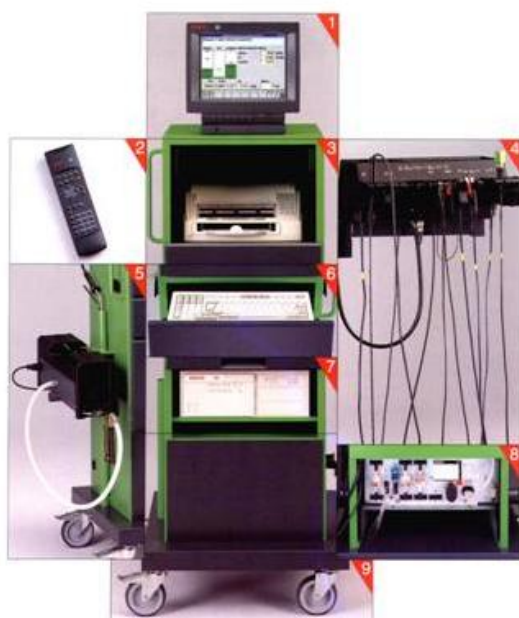
Obrázek č. 23 - Přístroj použitý k měření opacity vybraných motorů JCB, zdroj:
