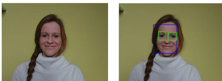
Obr. 2.7: Původní obraz a výsledný detekovaný obličej po využití metody s haarovými příznaky.
