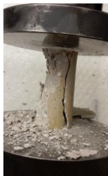
Obr. 29 zkouška pro vyhodnocení pevností v tlaku na přístroji P100-Labtest II
