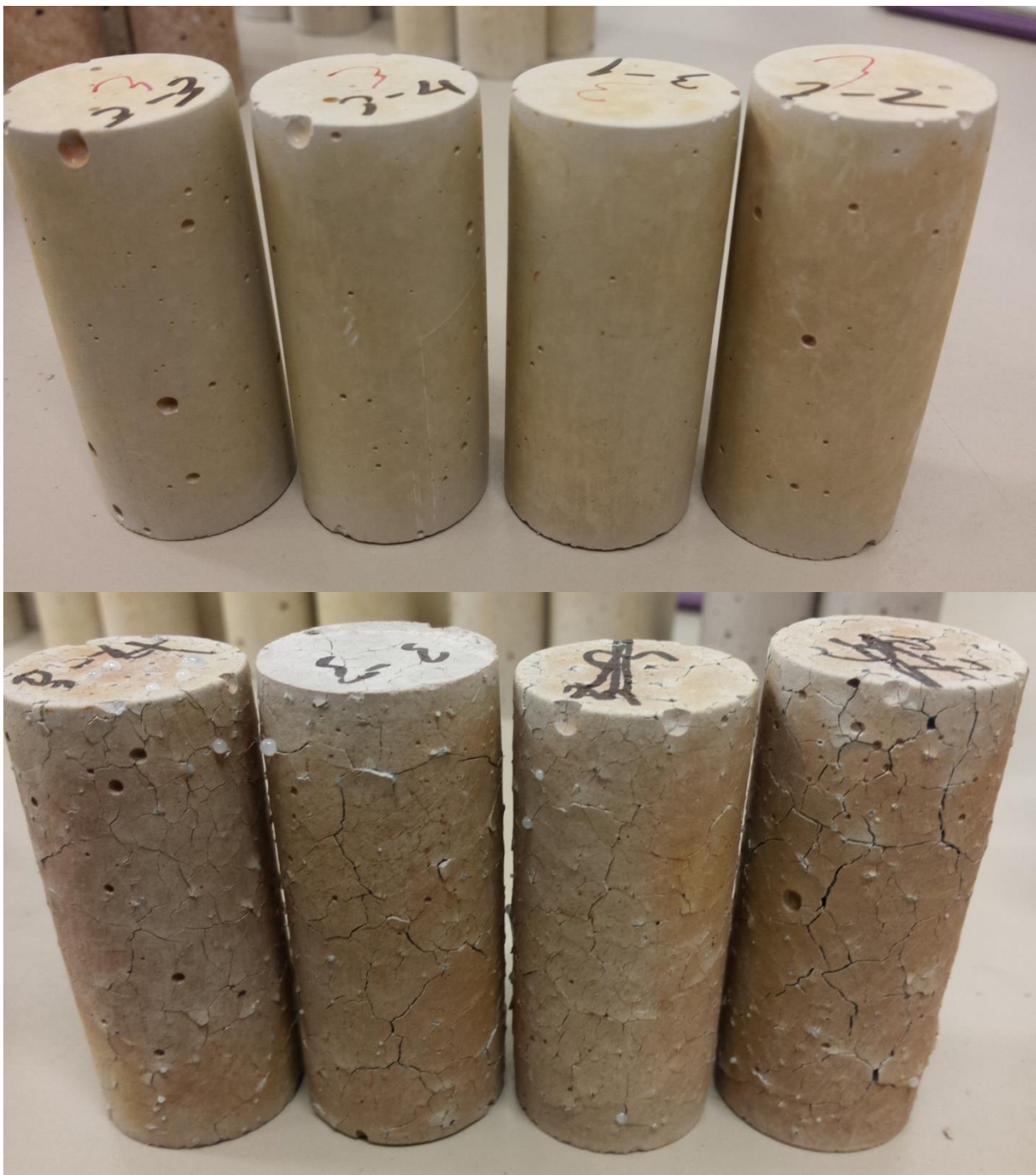
Obr. 55 Vzorek 3 před a po tepelné expozici
