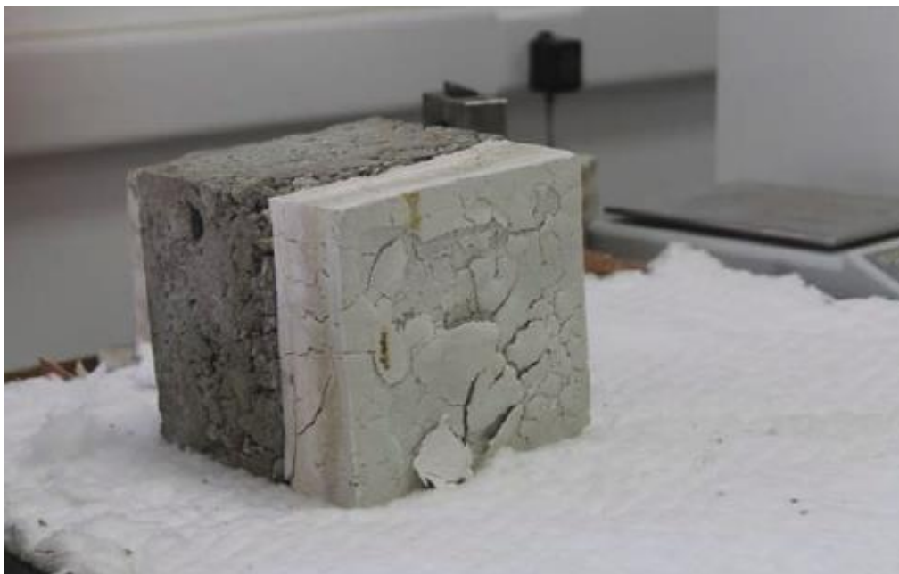
Obr. 11 vzorek po protipožární zkoušce [15]
