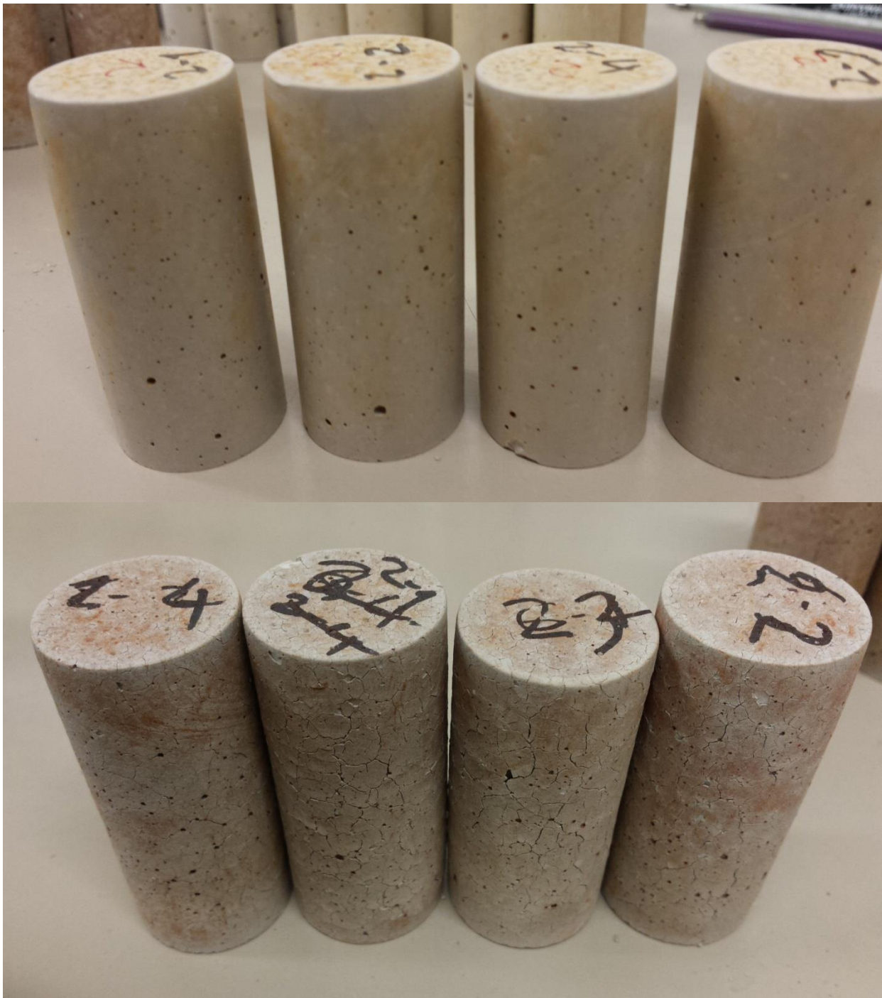
Obr. 54 Vzorek 2 před a po tepelné expozici
