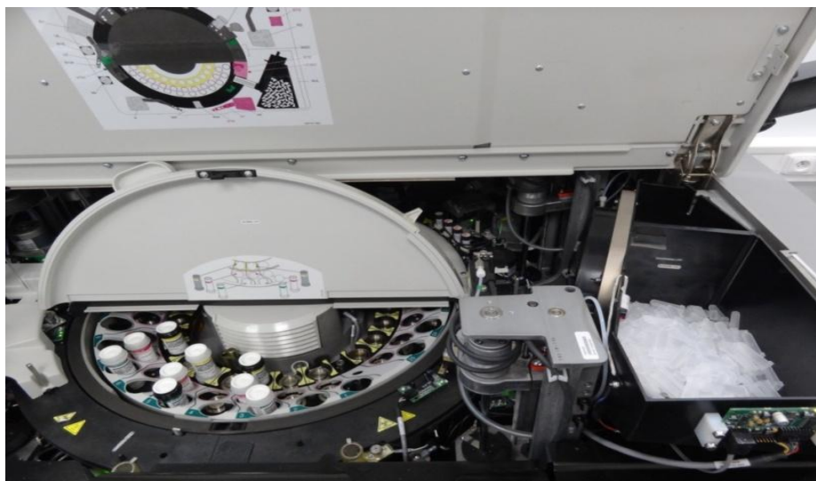
Obrázek 6: Procesní centrum analyzátoru Abbott Architect i2000 SR
