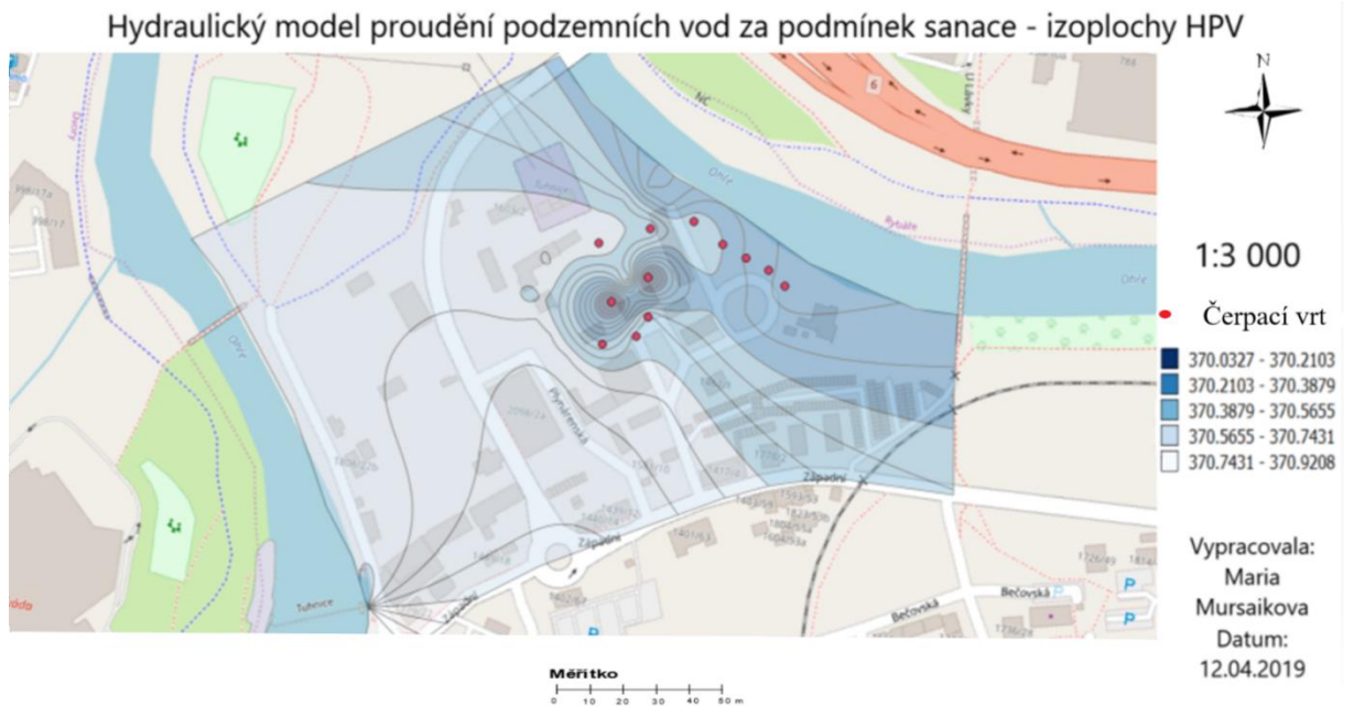
Obrázek 10 Výstup hydraulického modelu proudění podzemních vod za podmínek čerpání
