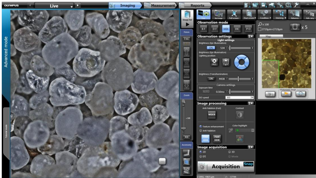
Obr. 3-4: Ukázka prostředí mikroskopu s pohledem na zrna ostřiva
