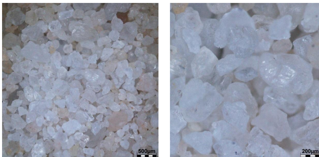
Obr. 3-13: Makroskopické snímky zrn křemenného ostřiva ST 54 (měřítko: 500 \mu\text{m} – vlevo; 200 \mu\text{m} - vpravo)
