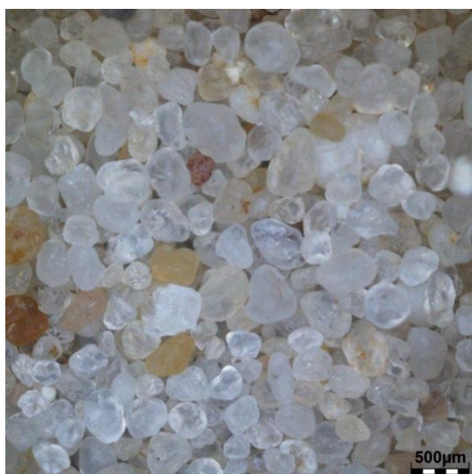
Obr. 3-8: Makroskopické snímky zrn ostřiva SH 33 (měřítko: 500 μm – vlevo; 200 μm – vpravo)
