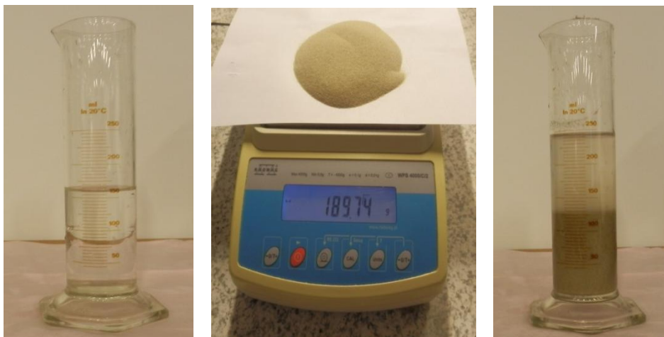
Obr. 3-43: Válec s vodou, navážka křemenného ostřiva III, válec s vodou a ostřivem III
