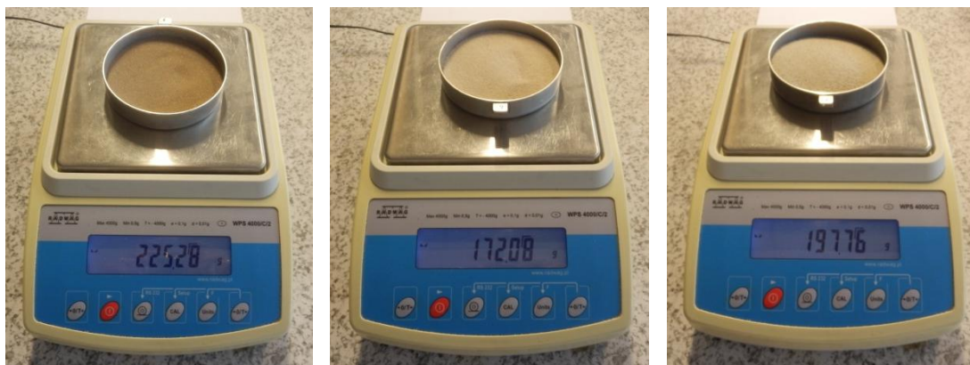
Obr. 3-26: Navážené hmotnosti zirkonového, křemenného ST 54 a křemenného ostřiva III po sušení
