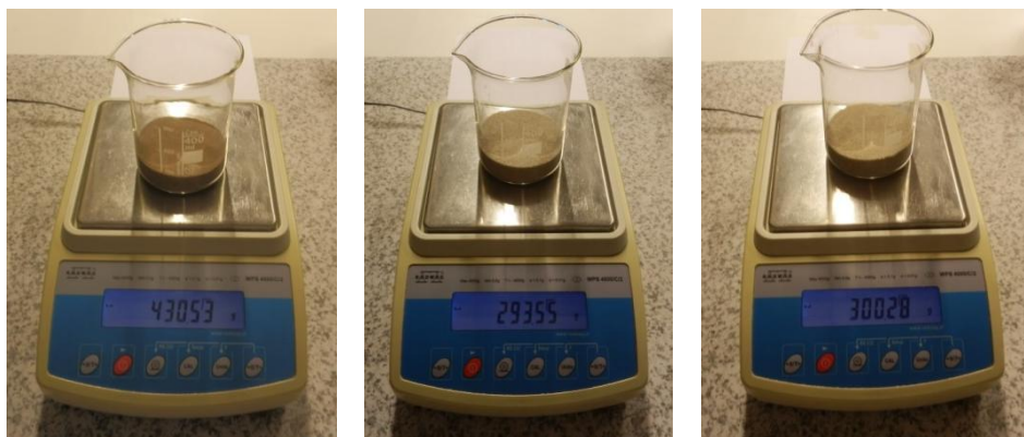
Obr. 3-34: Hmotnost kádinky s zirkonovým ostřivem, křemenným ostřivem ST 54 a křemenným ostřivem III
