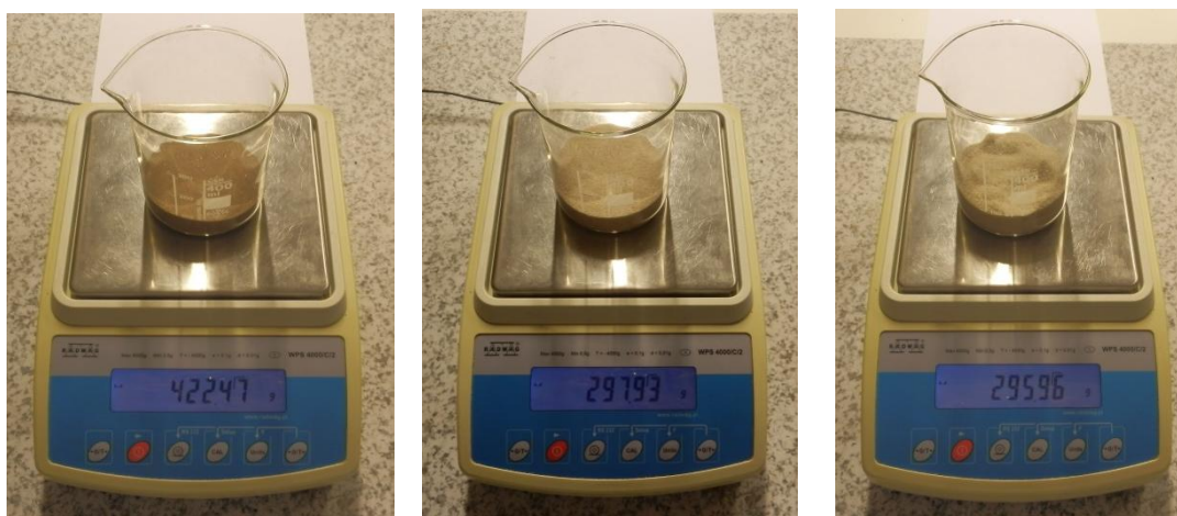
Obr. 3-39: Hmotnost kádinky s ostřivem: zirkonovým, křemenným ST 54 a křemenným III
