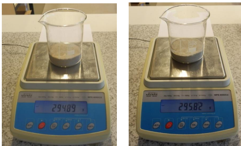
Obr. 3-37: Hmotnost kádinky s křemenným ostřivem ST 54 a křemenným ostřivem III
