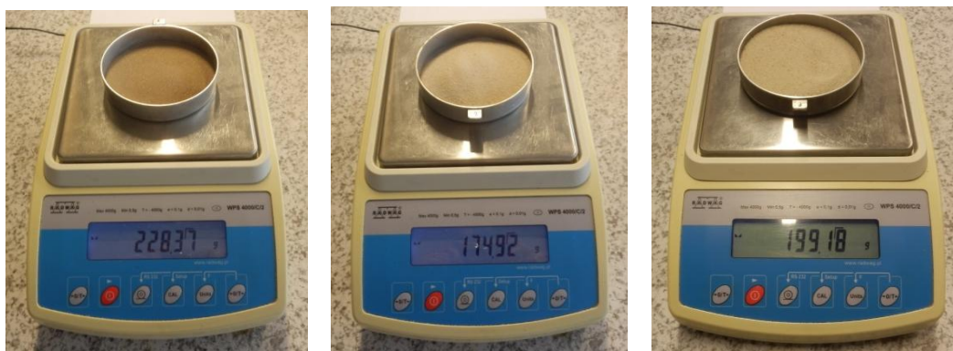
Obr. 3-25: Navážené hmotnosti zirkonového, křemenného ST 54 a křemenného ostřiva III před sušením
