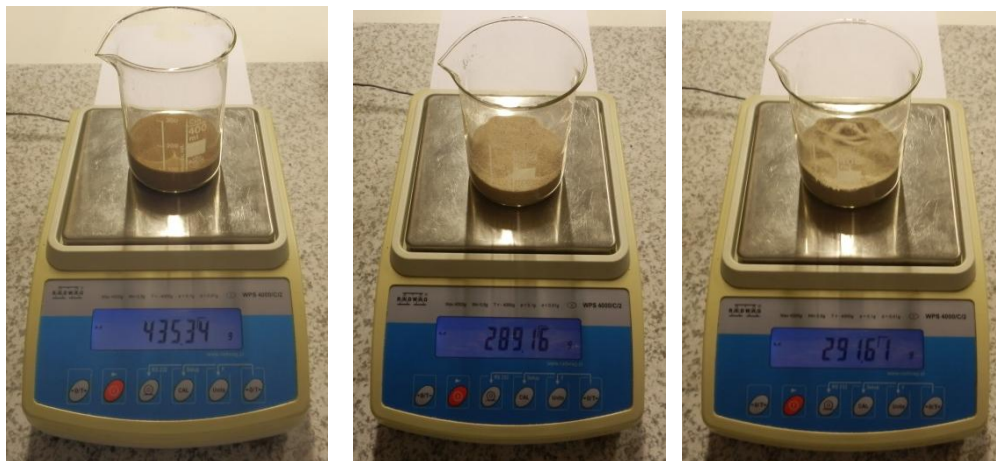
Obr. 3-41: Hmotnost kádinky s ostřivem: zirkonovým, křemenným ST 54 a křemenným III
