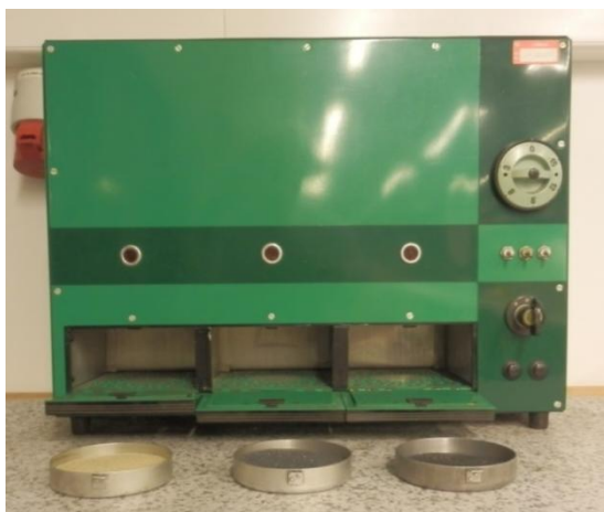
Obr. 3-21: Slévárenská laboratorní suška s ostřivy: SH33, korundové a chrommagnezitové
