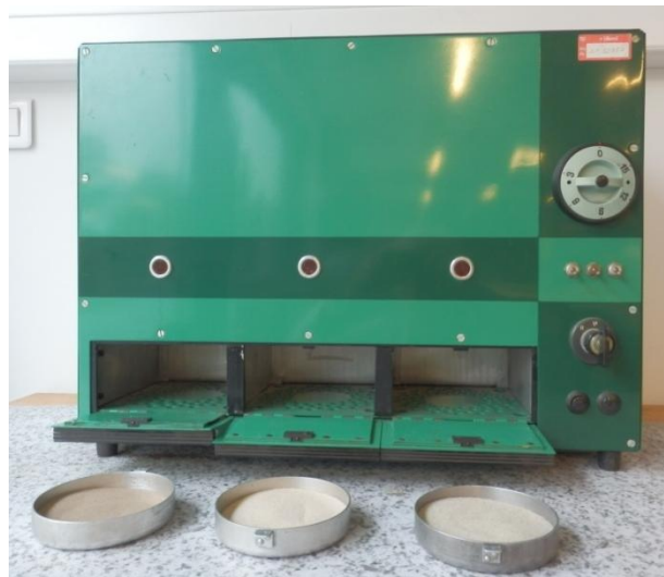
Obr. 3-24: Vysušená ostřiva: zirkonové, křemenné ST 54 a křemenné III
