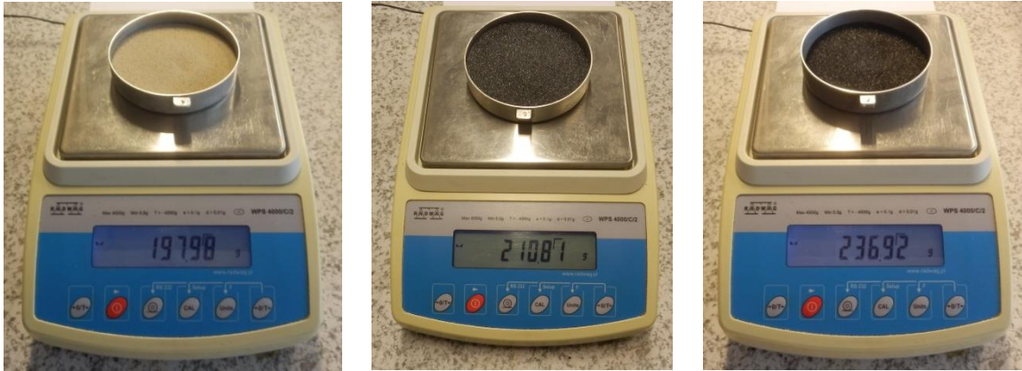
Obr. 3-23: Navážka křemenného ostřiva SH 33, korundového a chrommagnetitového ostřiva po sušení
