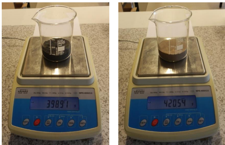
Obr. 3-36: Hmotnost kádinky s chrommagnezitovým a zirkonovým ostřivem
