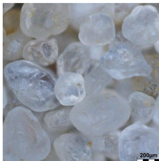
Obr. 3-8: Makroskopické snímky zrn ostřiva SH 33 (měřítko: 500 μm – vlevo; 200 μm – vpravo)
