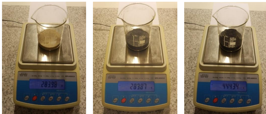
Obr. 3-33: Hmotnost kádinky s křemenným ostřivem SH 33, korundovým ostřivem a s chrommagnezitovým ostřivem
