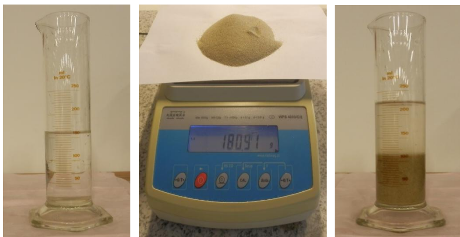
Obr. 3-42: Válec s vodou, navážka křemenného ostřiva SH 33, válec s vodou a ostřivem SH 33
