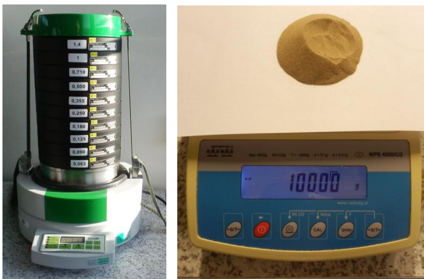
Obr. 3-1: Prosévací stroj a ukázka 100 g navážky ostřiva
