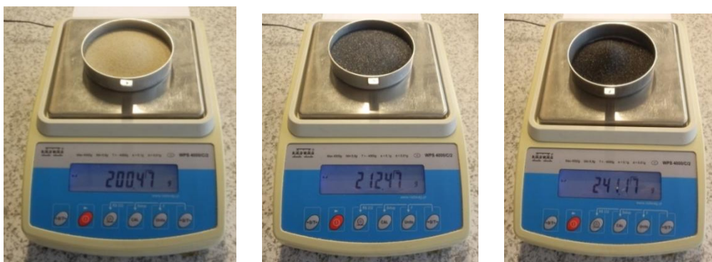
Obr. 3-22: Navážka křemenného ostřiva SH 33, korundového a chrommagnezitového ostřiva před sušením
