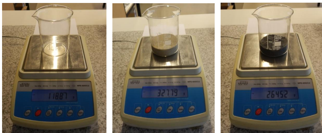
Obr. 3-35: Hmotnost prázdné kádinky, kádinky s křemenným ostřivem SH 33, s korundovým ostřivem
