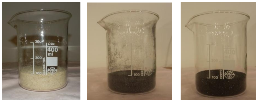
Obr. 3-27: Ostřiva: křemenné SH 33, korundové, chrommagnezitové
