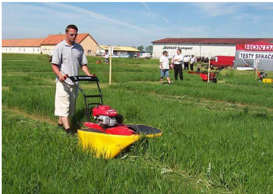
Obrázek 9 – Ukládání posečené trávy na posečenou plochu [14]
