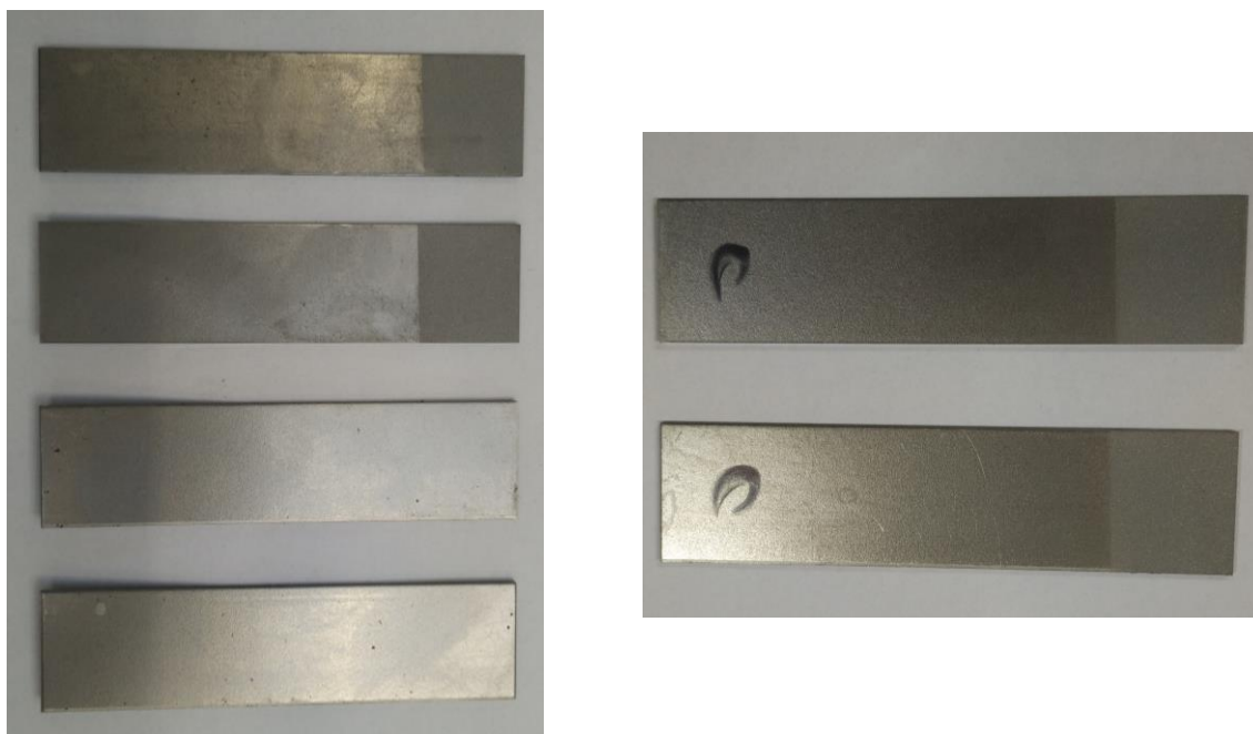
Obrázek 11 Vzhled vzorků při úpravě: vlevo – před a po otryskání, vpravo – po odstranění zbytků abraziva před nanesením lepidla ( Zdroj: vlastní zpracování )
