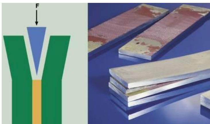
Obrázek 5 Schéma provedení (vlevo) a zkušební tělesa (vpravo) pro klínovou zkoušku (Zdroj: Joint Testing. Www.adhesives.org [online]. 2015 [cit. 2015-12-19]. Dostupné z: http://www.adhesives.org/adhesives-sealants/adhesives-sealants-overview/structural-design/joint-testing )
