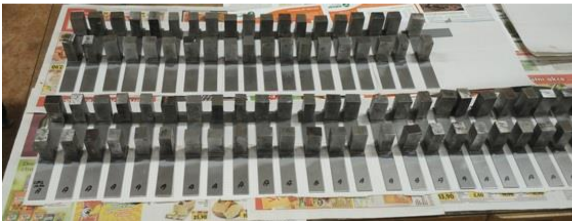
Obrázek 12 Vytvrzování zkušebních těles při zatížení lepené spáry ocelovým kvádrem (Zdroj: vlastní snímek)
