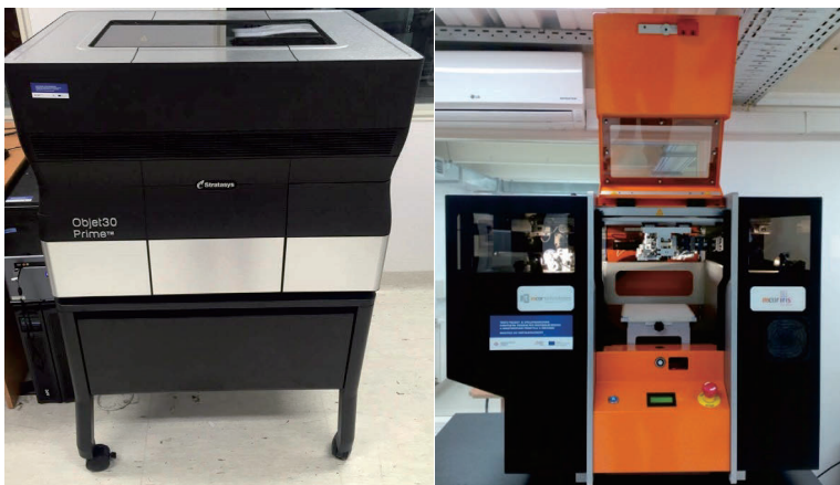
Obrázek 1: Ilustrační náhled strojů z prostředí UPrint 3D (vlevo - Stratasys Objet 30 Prime™, vpravo - Mcor IRIS HD)
