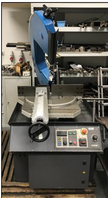
Obr. 12 – Pásová pila ARG 300 Plus H.F.
