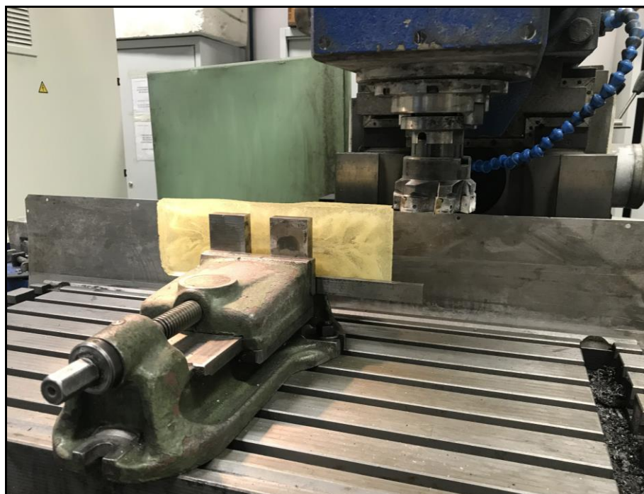
Obr. 10 – Proces zaúhlování vzorku z čisté epoxidové pryskyřice.
