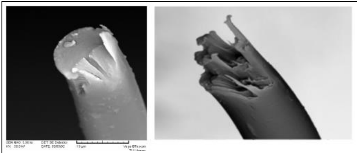
Obr. 7 – Příklady houževnatého lomu PES vláken. [7]
