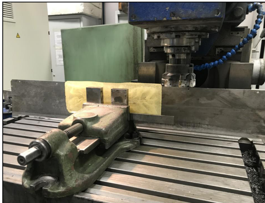
Obr. 10 – Proces zaúhlování vzorku z čisté epoxidové pryskyřice.
