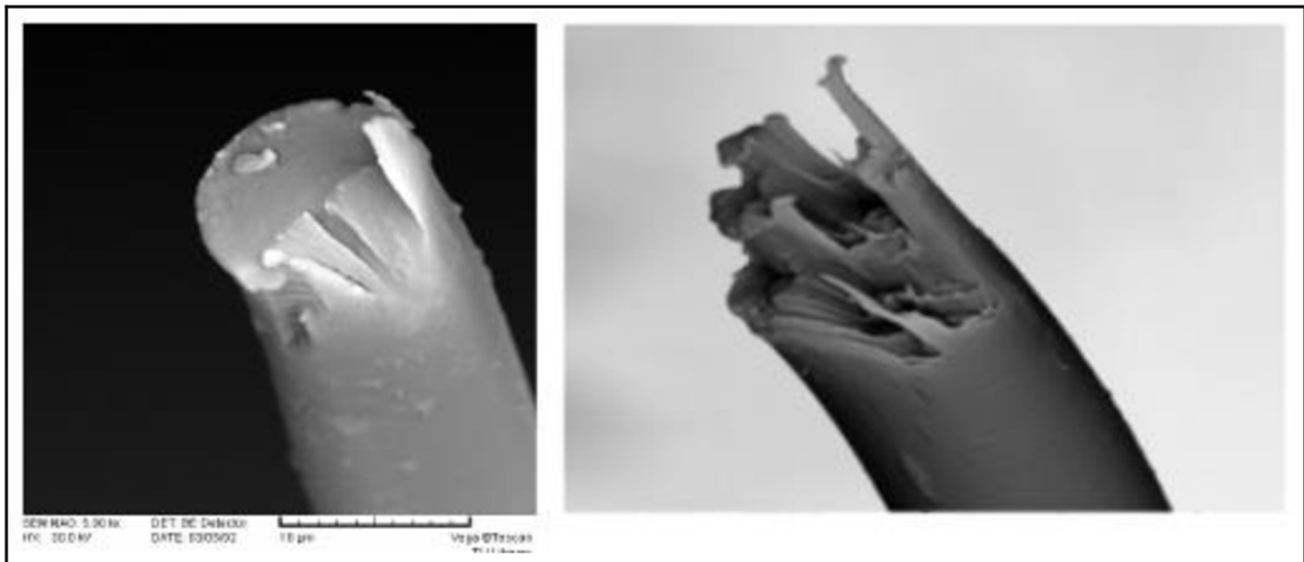
Obr. 7 – Příklad houževnatého lomu PES vláken. [7]
