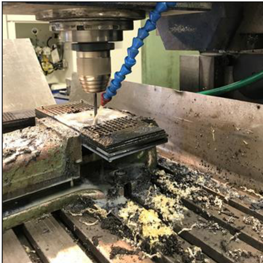
Obr. 22 – Pracoviště při procesu obrábění a vzniklé třísky.
