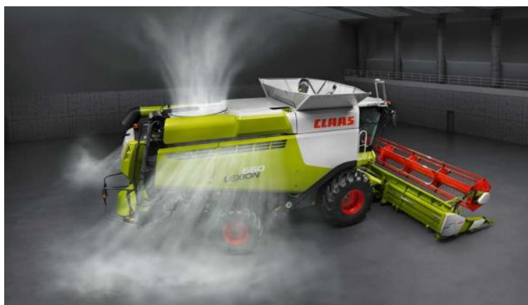
Obrázek 22 – Proudění vzduch chlazení motoru.
