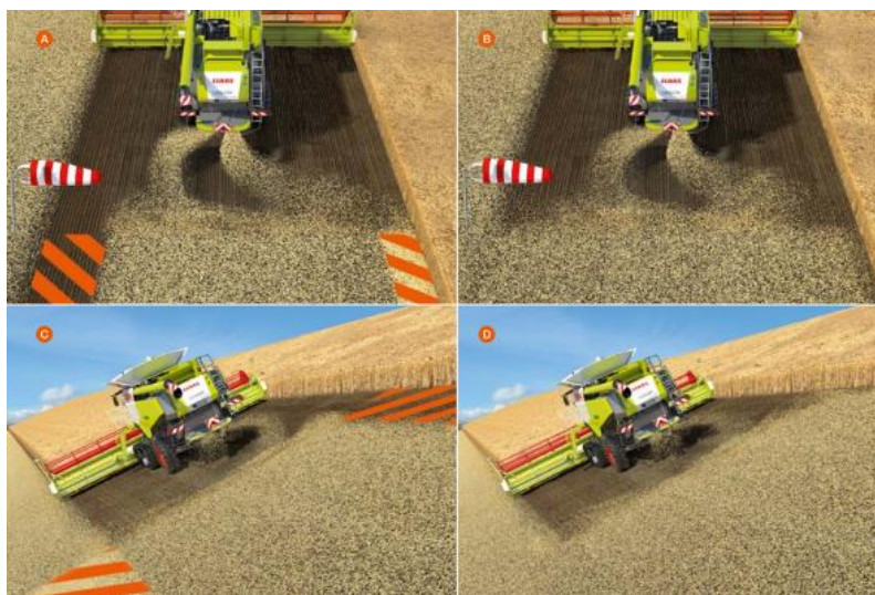
Obrázek 21 – Rozhoz řezanky při bočním větru.
