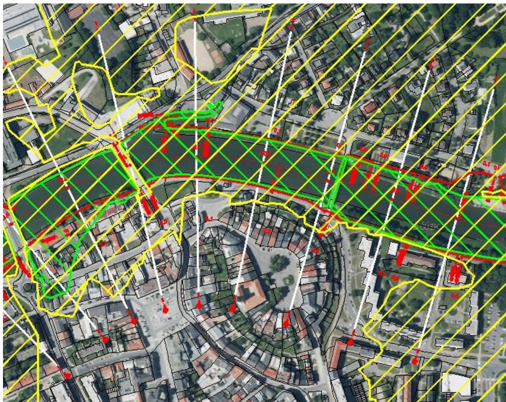
Obrázek 6.6 Vytvořené příčné řezy (bíle) podložené ortofoto mapou se zobrazením rozlivů Q20 (zeleně), Q100 (žlutě).
