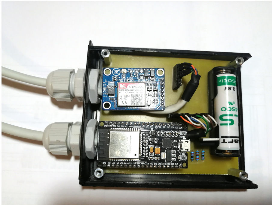
Obr. 2.13: Vyrobená krabička pro osazenou desku
