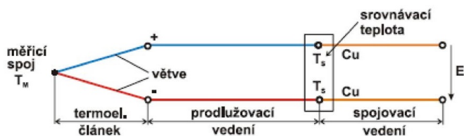
Obr. 1.1: Princip měření teploty [16]
