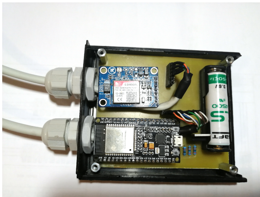
Obr. 2.13: Vyrobená krabička pro osazenou desku
