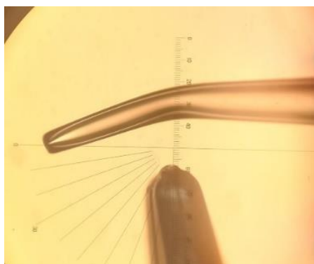
Obrázek 6: ohybání holdिंगové pipety (foto autor)
