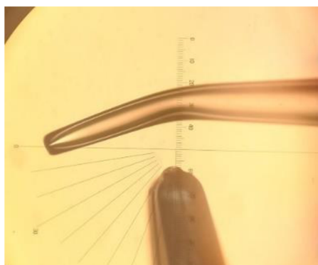
Obrázek 6: ohybání holdingové pipety (foto autor)
