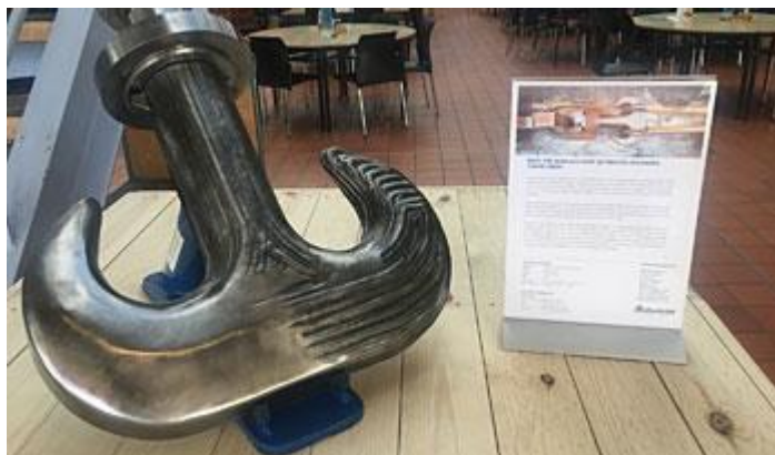
Obrázek 13 - První hák vyrobený pomocí 3D technologie
